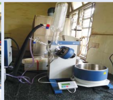
Rota evaporator र chiller
